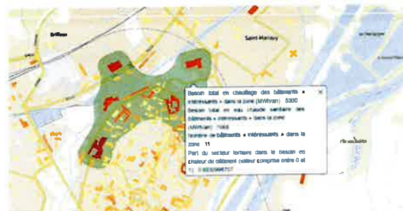
Identifier les zones regroupant des bâtiments « intéressants » pour un projet de réseau de chaleur
